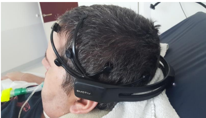
Fig.6: Casque EEG muni de 14 électrodes et posé sur ma tête.
