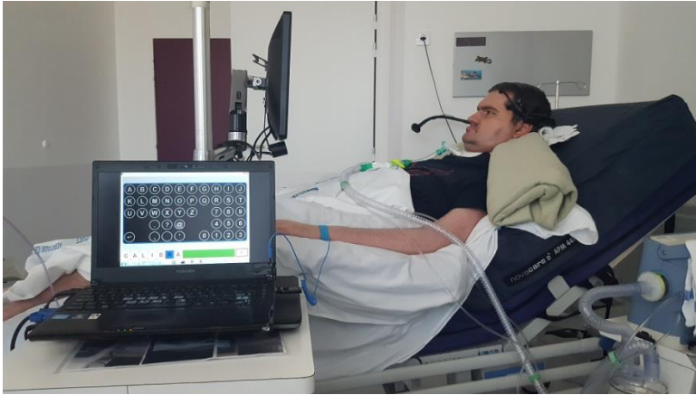
Fig.3: Dispositif expérimental: je suis alité et porte un casque EEG sur la tête. L'écran placé devant moi affiche le clavier virtuel du logiciel OpenViBE.
